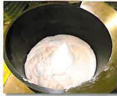
In der Mitte des Trichters befindet sich ein spitzer Kunststoff-Kegel, der den eingefüllten Teig teilt und so einen Teil des durch das Teigeigengewicht entstehenden Drucks von der Bodengrundfläche nimmt.
