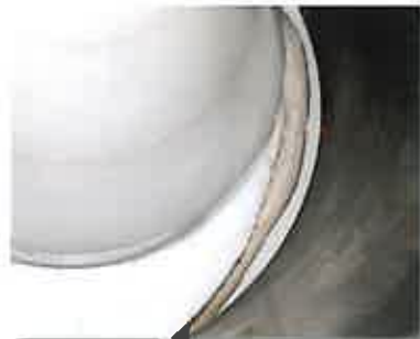
Der Boden des leicht gekippten Teigtrichters besteht aus einer scharfkantigen Kunststoffscheibe. Ihr Abstand zum Rand ist verstellbar, so dass an der tiefsten Stelle ein Spalt entsteht.
