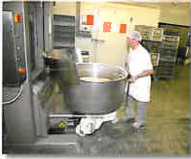
An den Hebekipper mit 700 kg Traglast hat ein Schlosser eine Leiter geschweißt. Da der Teigtrichter der Ceres ein Fassungsvermögen von 300 l hat, ist kein zusätzlicher Vorportionierer erforderlich.
