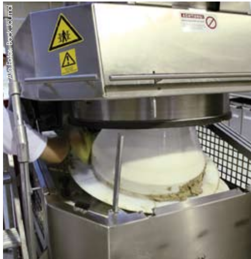
links: Durch das Anheben des Maschinenoberteiles ist der Kegel im Trichter zugänglich und kann für die nächste Brotsorte von Teigresten befreit werden. Mitte und rechts: Der Bänderrundwirker von König hinter der zweiten Ceres bewältigt problemlos die weichen Roggen- und Mischbrotteige der Bäckerei Raddatz.
