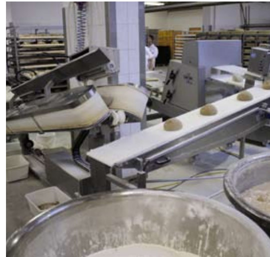
links: Durch das Anheben des Maschinenoberteiles ist der Kegel im Trichter zugänglich und kann für die nächste Brotsorte von Teigresten befreit werden. Mitte und rechts: Der Bänderrundwirker von König hinter der zweiten Ceres bewältigt problemlos die weichen Roggen- und Mischbrotteige der Bäckerei Raddatz.
