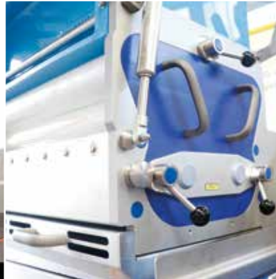
Stanzstation mit einfach wechselbaren Schneide- und Stanzwerkzeugen
