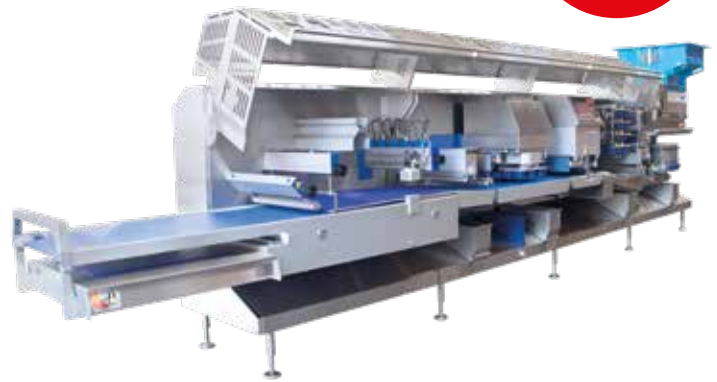
Formrollen zur Teigbandformung einfach herausnehmbar und einzeln einstellbar
