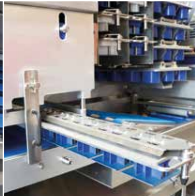
Mehl- und Streubehälter durch einfachen Einschub wechselbar
