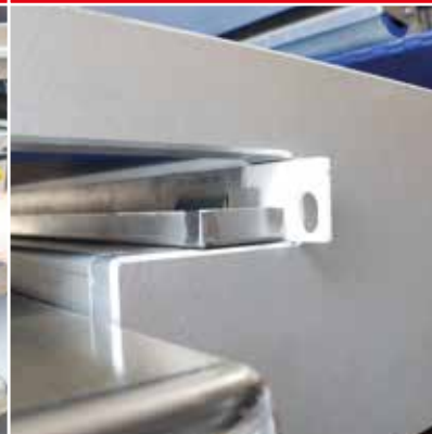
Abstreifer zur Reinigung des Abziehbandes
