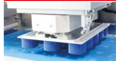
Reihenflexible Rundwirkstation für schonendes Wirken und breite Gewichtsgebiete
