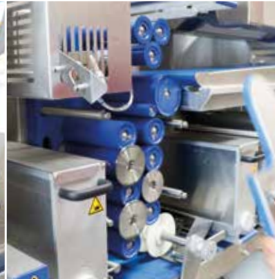
Einsätze der Rundwirkstation einfach wechselbar, Wirkbecher zerlegbar
