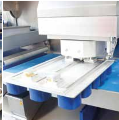
Abstreifer zur Reinigung des Abziehbandes
