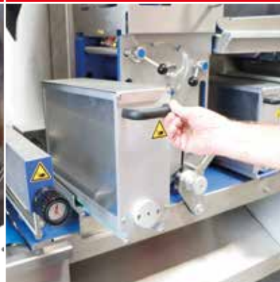
Mehl- und Streubehälter durch einfachen Einschub wechselbar
