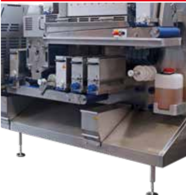
Schräge Flächen und großzügige Bodenfreiheit verhindern Ablagerungen
