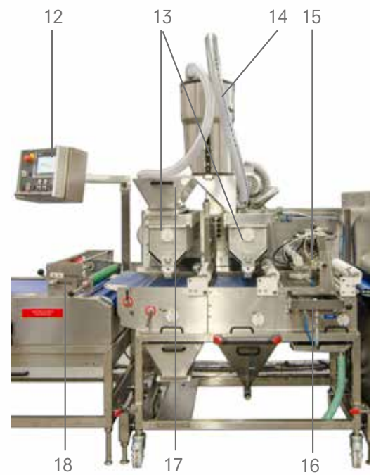
Gitterbändermodul auf fahbarem Rahmen austauschbar gegen optionales Transportband
