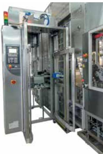
Der Servomat ist das automatische Blechstapelgerät von König, das die belegten Bleche (oder andere Gärgut- oder Backgutträger) aus der Absetzvorrichtung der Anlage selbsttätig entnimmt und in einen Stikken oder eine ähnliche Vorrichtung einbringt. So wird der Backwagen automatisch bestückt und ist zum Abbacken bereit. Gerade bei größeren Mengen eine enorme Arbeiterleichterung, die zudem den Bediener für andere Tätigkeiten freispielt!
