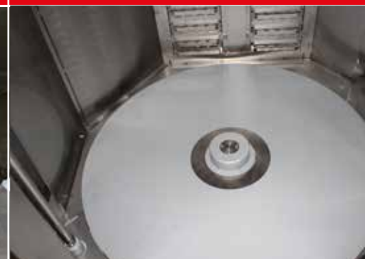
Drehteller mit Labyrinthsystem sorgt für besten Schutz gegen Ablagerungen
