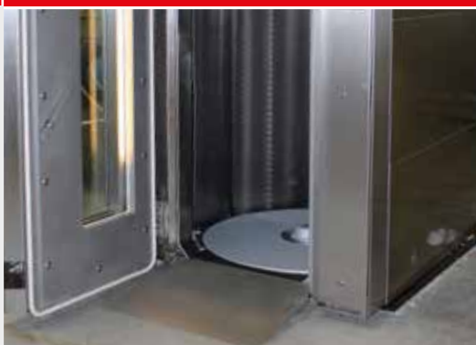
Rund-um abgedichtete Tür für minimierten Wärmeverlust
