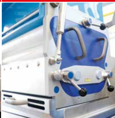
Estaciones de formado, estampado plegado de remoción fácil sin herramientas.
