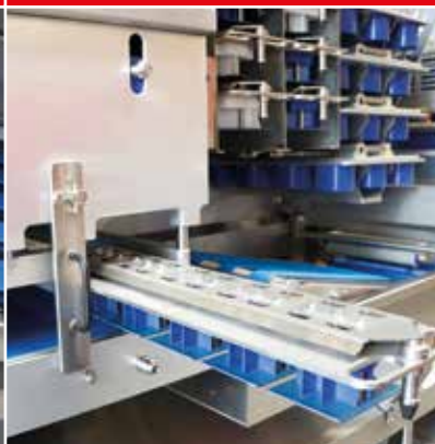
Cajas de harina y semillas de fácil extracción mediante clavijas.
