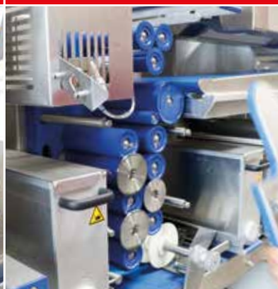
Herramientas de redondeo extraíbles, copas de redondeo (boleo) extraíbles
