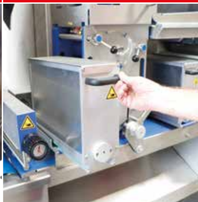
Cajas de harina y semillas de fácil extracción mediante clavijas.
