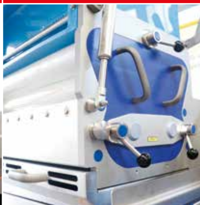
Станция штамповки с легкосъёмным резательным и штаповочным инструментом
