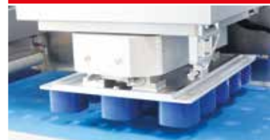
станция округления, адаптируемая к рядности рабочего потока
