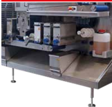
Наружные поверхности установки выполнены под углом и с большим пространством под ней – для предотвращения скапливания грязи
