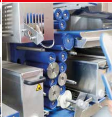
Легкосъёмные и взаимозаменяемые элементы станции округления. Сборно-разборный инструмент, округления, цилиндрические
