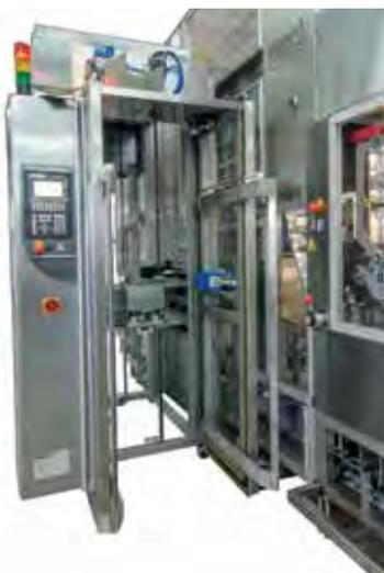
Servomat es un sistema mecánico de alta ingeniería donde es posible traspasar los productos desde la línea a las bandejas y trasladar las bandejas automáticamente a los carros que después irán a la cámara de fermentación y posteriormente a los hornos para el término del proceso de panificación.
