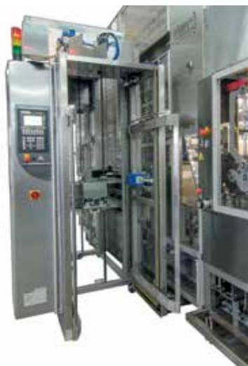
Сервомат – это автоматическое устройство от Кёниг для штабелирования противней, самостоятельно вынимающее противни (либо носители для расстойки или выпечки) со станции отсадки изделий и укладывающее их в хлебопекарную тележку. Тележка загружается автоматически и готова к отправке на выпечку. При больших объёмах возможно значительное облегчение работы, которое высвобождает оператора для других производственных задач!
