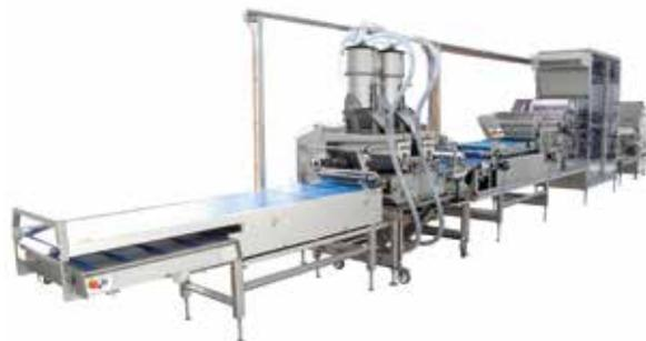
Koenig rediseñó la línea de panecillos Combiline, probada mundialmente, para facilitar aún más la limpieza, el mantenimiento y el acceso a todos los módulos con el diseño "Easy Clean"
