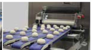
Die Teigteil- und Wirkmaschine Rex Futura Multi produziert nach dem "Rex Prinzip" - mit hoher Teigschonung und hoher Gewichtsgenauigkeit in einem breiten Gewichtsbereich
