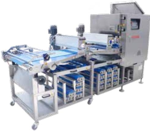
Con la Rex Futura Multi, hemos marcado otro hito en el rango de peso. El principio probado Rex y las barras de pesaje fácilmente intercambiables permiten el procesamiento de un rango de peso ampliado de 12 a 245 g (moldeado) o 600 g (sin moldear).
