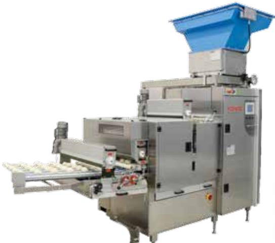
Zwei unterschiedliche Trommelleisten und unterschiedliche Kammergrößen ermöglichen eine Erweiterung der Bandbreite der Verarbeitungsgewichte. Damit ist eine Kombination aus verschiedenen Gewichtsbereichen möglich.
