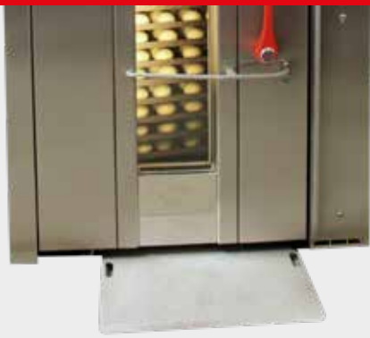
Заездная рампа легко снимается без использования инструмента
