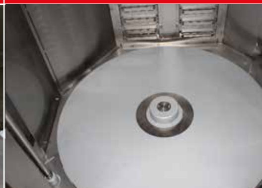
Система каналов под вращающимся подом печи служит предотвращению загрязнения пода печи
