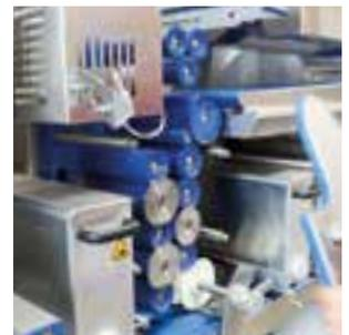
▲ Formrollen zur Teigbandformung einfach herausnehmbar und einzeln einstellbar
