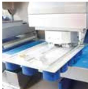
▲ Einsätze der Rundwirkstation einfach wechselbar, Wirkbecher zerlegbar
