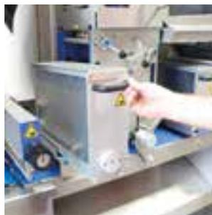
▲ Mehl- und Streubehälter durch einfachen Einschub wechselbar
