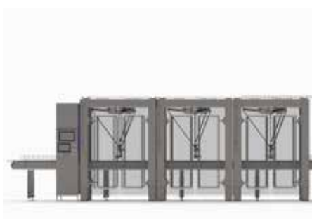
Delta-Version mit 3 Robotern und rotierenden Messern, Wasserstrahl- und Ultraschallwerkzeugen
