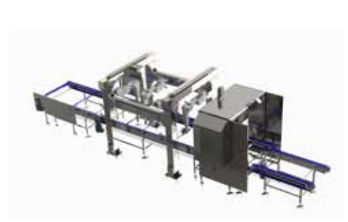
Arm-Roboter-Version mit 12 Köpfen für 12 gleichzeitige Schnitte
