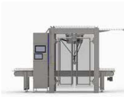
Delta-Version mit 1 Roboter und rotierenden Messern, Wasserstrahl- und Ultraschallwerkzeugen
