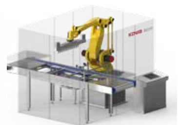
Arm-Roboter-Version mit 12 Köpfen für 12 gleichzeitige Schnitte
