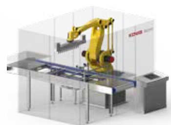
Arm-Roboter-Version mit 12 Köpfen für 12 gleichzeitige Schnitte
