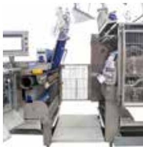
▲ Geteilte Maschine: Durchgang durch die Maschine ist vollständig möglich
